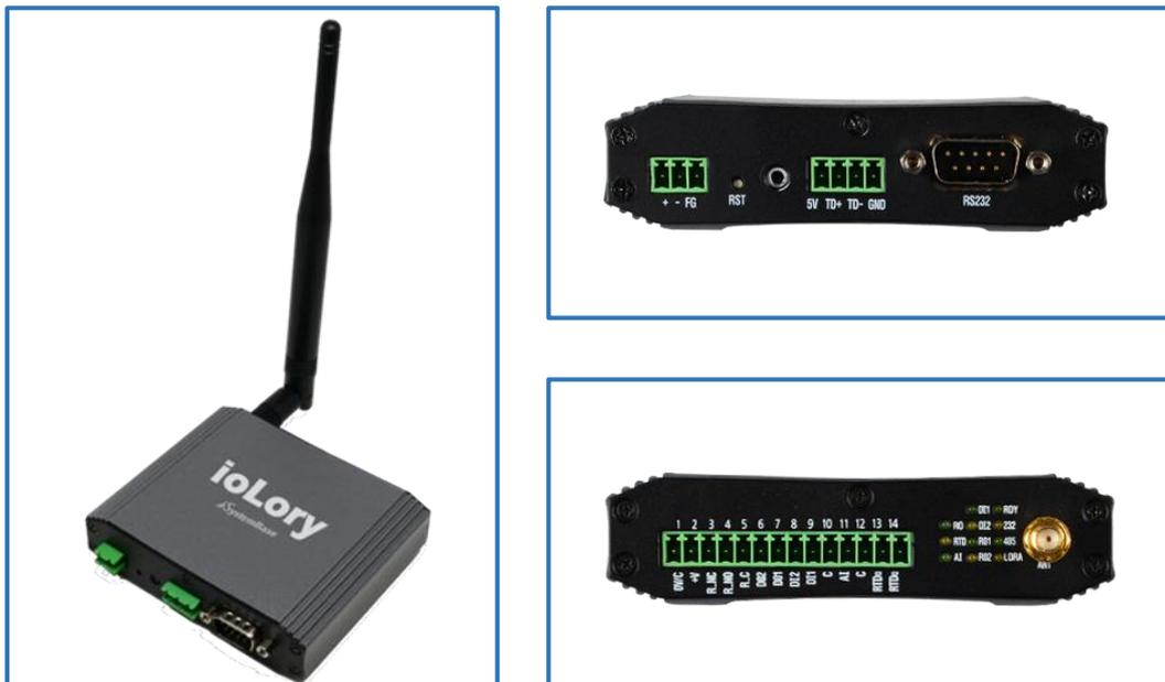
LoRa는 센서 네트워크용 무선 통신 기술로써, 소량의 데이터를 장거리에 전달 할 수 있는 차세대 LPWA(Low Power Wide Area) 통신 기술이다. 시스템베이스의 ioLory는 제어영역에서 널리 사용 되는 On/Off용 Relay 출력과 RS232/485를 제공합니다. 또한 Digital input/Output, Analog Input, RTD 등을 제공하여 산업현장의 각종 계측장비 및 센서류, 액츄에이터의 데이터 수집, 제어, 모니터링에 활용 등 다양한 요구조건에 맞추어 사용자가 원하는 기능을 제공하는 ODMU (One-Device-Multi-Use) 장비다.
